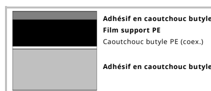
Coupe transversale schématique de la bande DENSOLEN®-AS30
